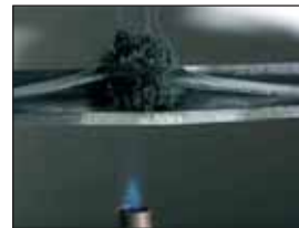
Junta de dilatación en expansión por causa del fuego
