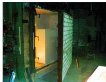
Armario de seguridad según UNE-EN comprobado en un horno de pruebas.
